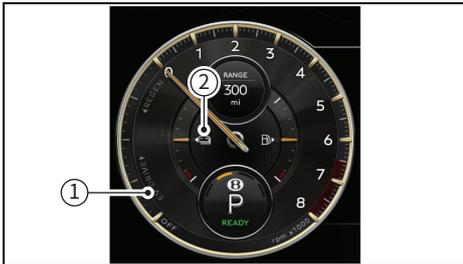
"EV DRIVE" (1) e indicatore batteria ad alta tensione (2) sul quadro strumenti
